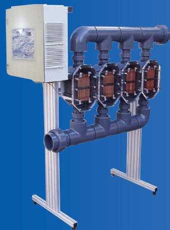
Die Wasseraufbereitungsanlage ist komplett vormontiert mit (Cu/Ag) Behandlungszellen (je nach Poolgröße), die elektrisch verrohrt und verdrahtet auf einem Alu-Gestell montiert sind. Empfehlenswert ist die By-Pass Montage, um Wartungsarbeiten auch während des Betriebes zu gewährleisten. Ein Mess-System Kupfer wird mitgeliefert. Standardverrohrung = Ø 110 mm
