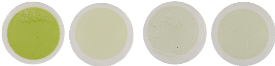
Abbildung 2: Filtrationsrückstände (von links nach rechts: Kontrolle, 0,7, 1,0 1,7 ppm Cu) zeigen die Wirkung der Cu/Ag-Behandlung auf die Algenentwicklung
